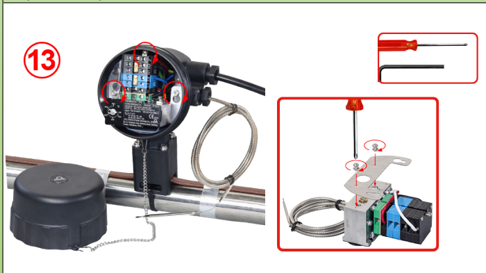
13 : Étape 1 : Fixez le thermostat antidéflagrant KA sur le support à l'aide de vis M4 (couple de serrage : 1,2 N·m). Étape 2 : Fixez le support et le thermostat antidéflagrant KA à l'aide de deux vis M5 (couple de serrage : 2 N·m). Étape 3 : Raccordez le câble de traçage et l'alimentation aux borniers, conformément aux schémas électriques A0, B0, C0 et D0
